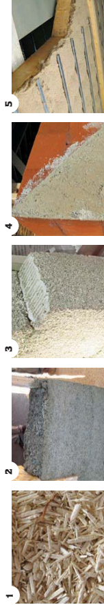
1. Chènevotte | 2. Béton de chanvre | 3. Bloc de béton de chanvre | 4. Enduit chaux-chanvre | 5. Laine de chanvre
